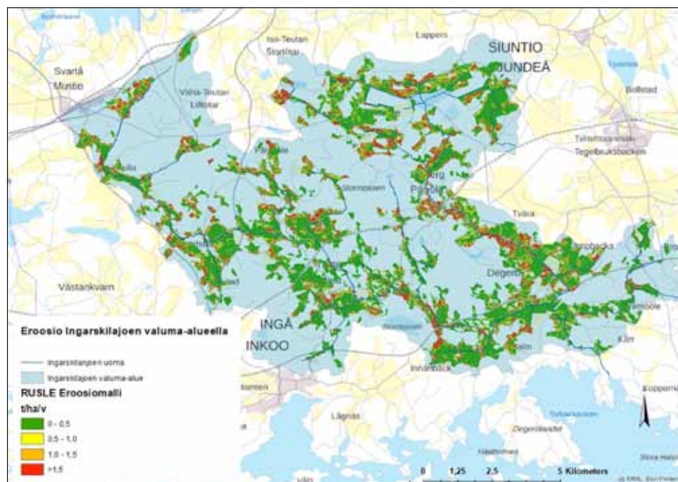
Kuva 2 Ingarskilaanjoen peltolohkojen RUSLE-eroosiomalli (Aineisto: Luonnonvarakeskus 2017)
